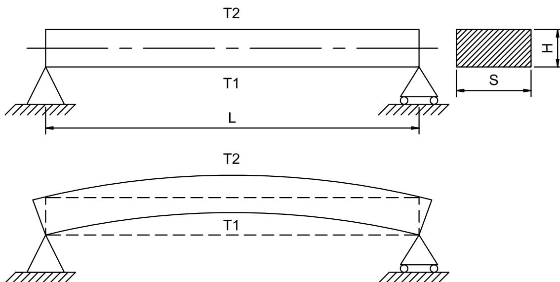
Questo fenomeno, particolarmente visibile nelle aperture a nei profilati molto lunghi, è noto come **distorsione termica**, e questa deformazione, nei casi peggiori e durante le ore di maggiore irraggiamento solare, può causare difficoltà di apertura e chiusura di finestre e porte o generare altri tipi di malfunzionamento.
