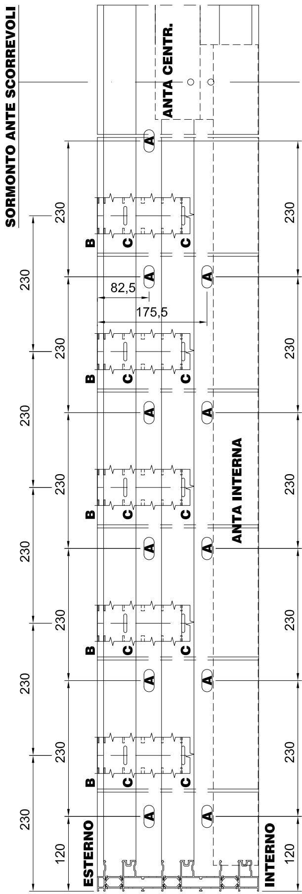
ATTENZIONE: NEI SERRAMENTI CON TELAIO TRE BINARI LA DISTANZA TRA UNO SCARICO ACQUA E L'ALTRO DEVE ESSERE VALUTATA DI VOLTA IN VOLTA A SECONDA DELLA LARGHEZZA DEL SERRAMENTO. IL PASSO RIPORTATO NEL PRESENTE CATALOGO E' PURAMENTE INDICATIVO
