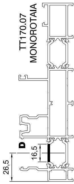
**D** = Asola 36x16,5 mm, con pantografo
