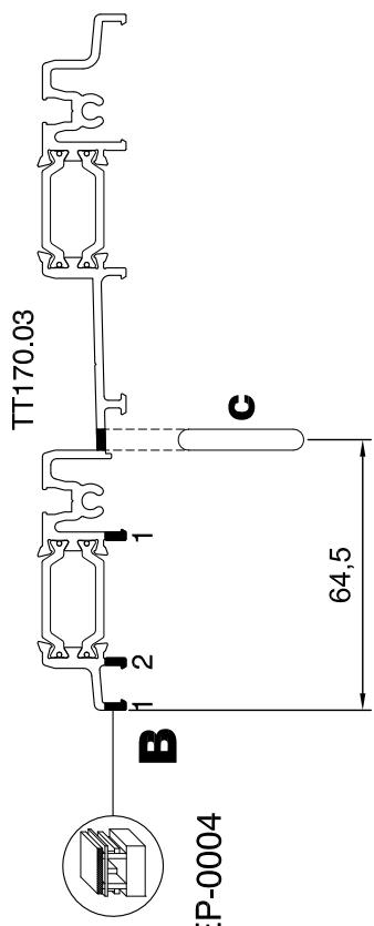
**C**=Asola 30x5 mm., con pantografo
