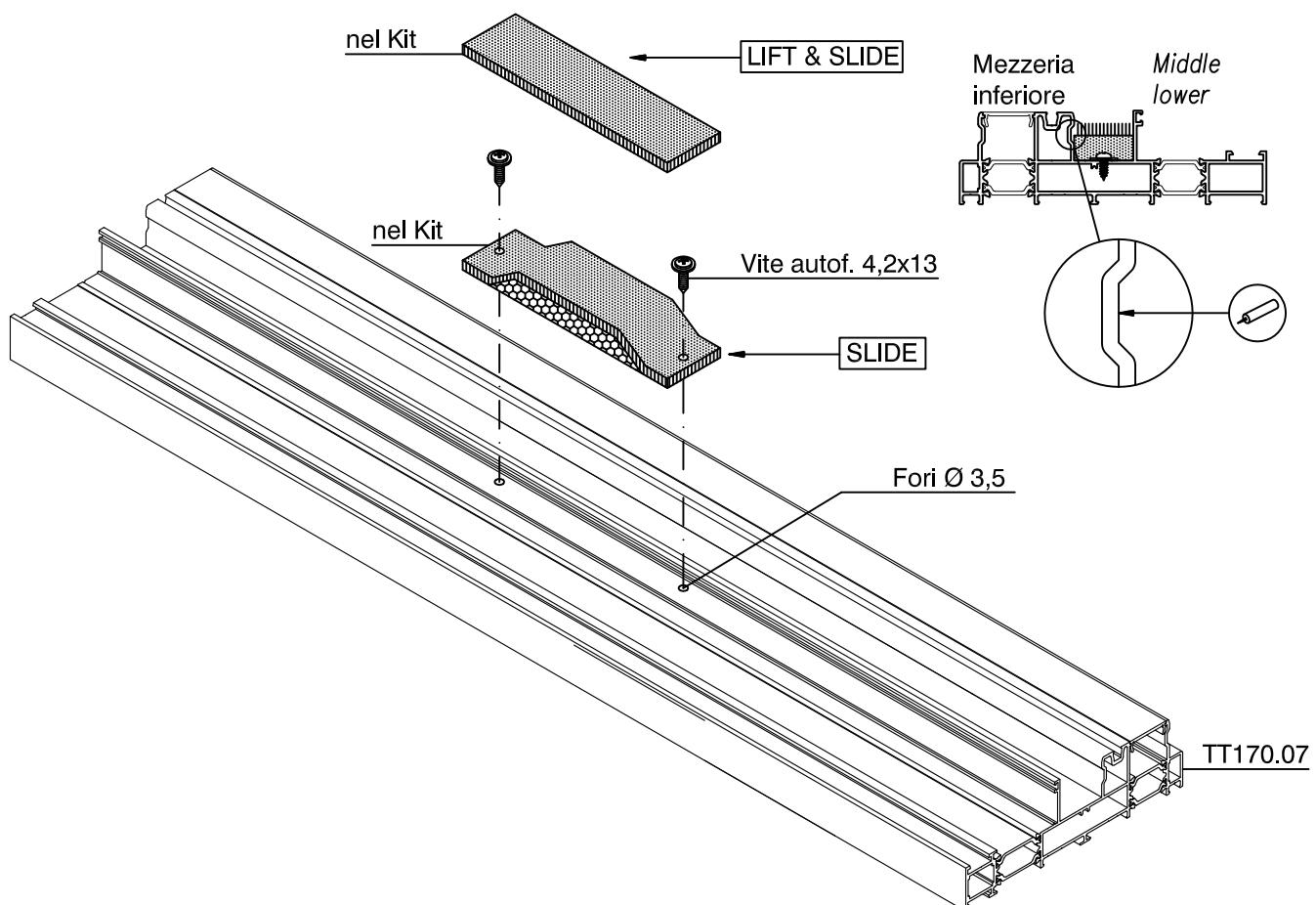
POSIZIONARE AL CENTRO DELLA SEZIONE – Place in the middle of the section
