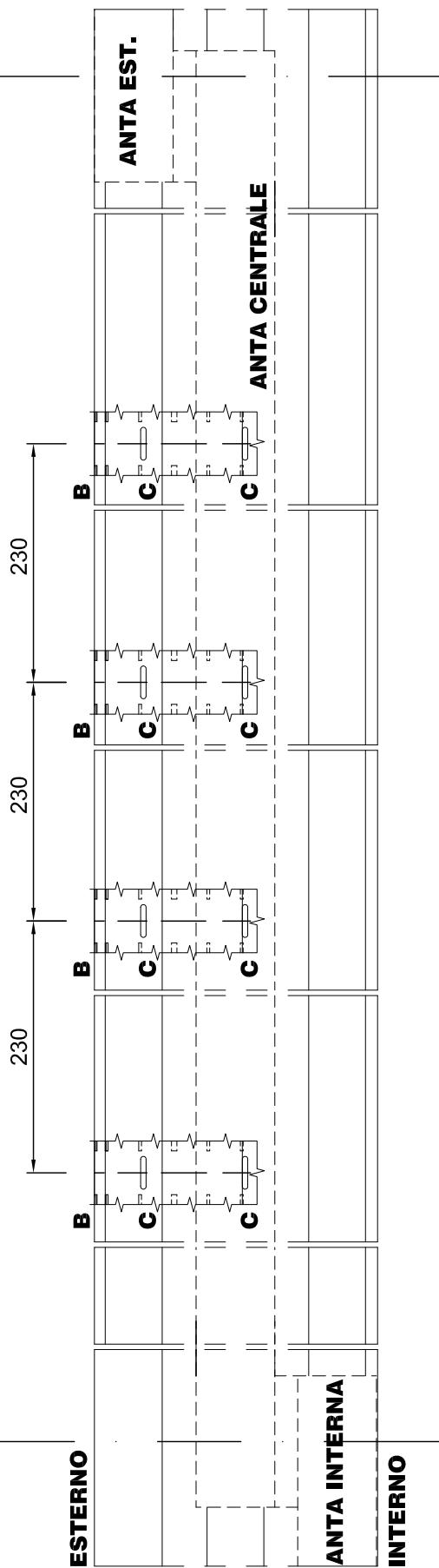
ATTENZIONE: NEI SERRAMENTI CON TELAIO TRE BINARI LA DISTANZA TRA UNO SCARICO ACQUA E L'ALTRO DEVE ESSERE VALUTATA DI VOLTA IN VOLTA A SECONDA DELLA LARGHEZZA DEL SERRAMENTO.
