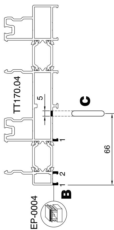
**C**=Asola 30x5 mm., con pantografo
