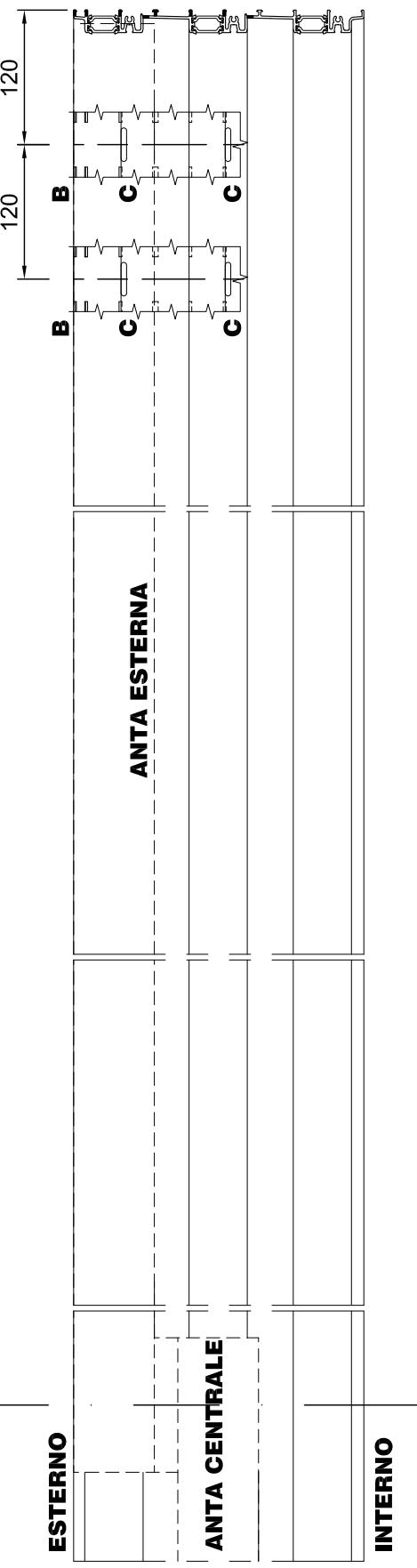
ATTENZIONE: NEI SERRAMENTI CON TELAIO TRE BINARI LA DISTANZA TRA UNO SCARICO ACQUA E L'ALTRO DEVE ESSERE VALUTATA DI VOLTA IN VOLTA A SECONDA DELLA LARGHEZZA DEL SERRAMENTO.
