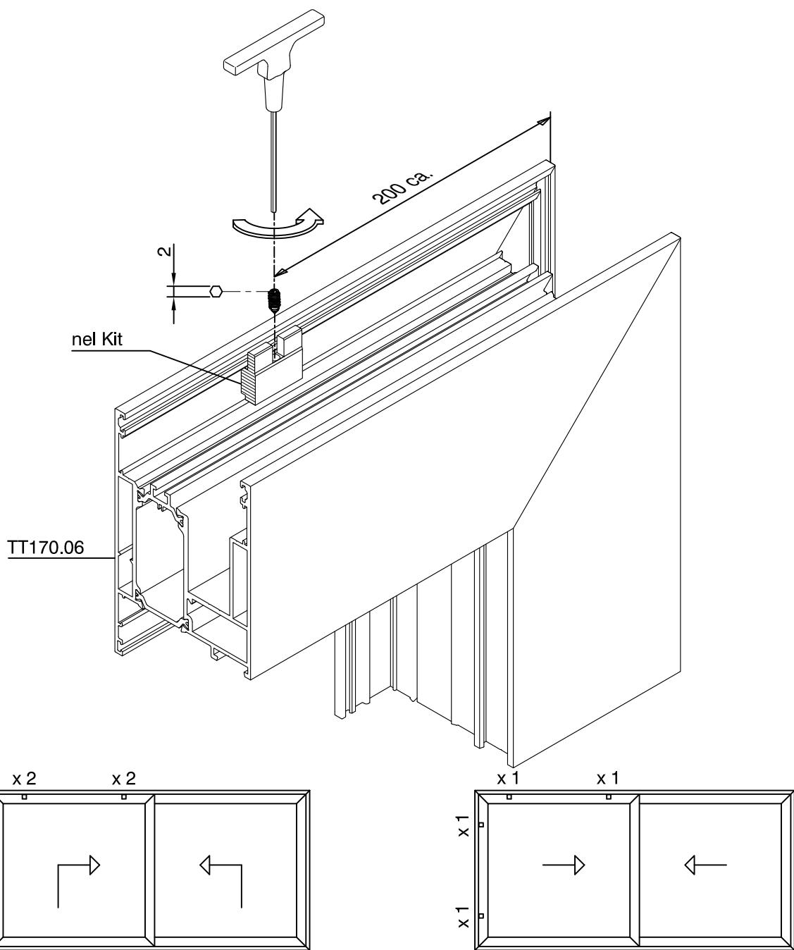
Si inserisce anche ad anta assemblata - It also enters with door assembled
