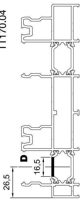
**D** = Asola 36x16,5 mm, con pantografo
