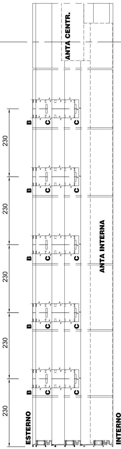
ATTENZIONE: NEI SERRAMENTI CON TELAIO TRE BINARI LA DISTANZA TRA UNO SCARICO ACQUA E L'ALTRO DEVE ESSERE VALUTATA DI VOLTA IN VOLTA A SECONDA DELLA LARGHEZZA DEL SERRAMENTO. IL PASSO RIPORTATO NEL PRESENTE CATALOGO E' PURAMENTE INDICATIVO
