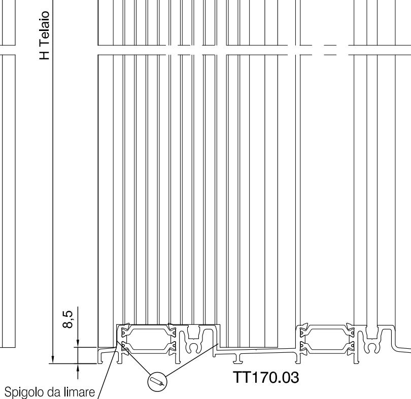
(\*) Prima di effettuare il foro, per il fissaggio, accertarsi che il dentino posteriore sia agganciato al telaio.
