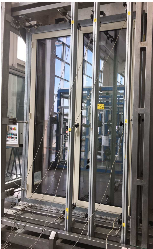
Foto 1. Campione sottoposto a prova durante i test di resistenza al carico del vento
