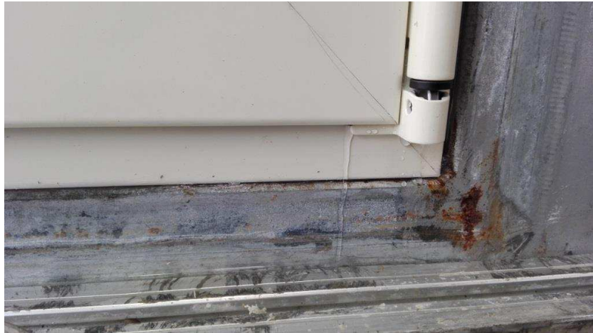
Foto 2. Campione sottoposto a prova durante i test di tenuta all'acqua
