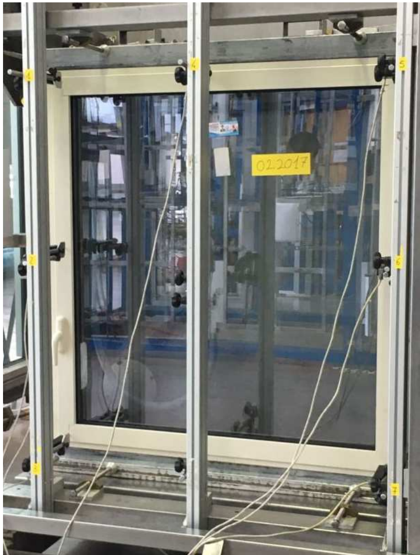
Foto 3. Campione sottoposto a prova durante i test di resistenza al carico del vento
